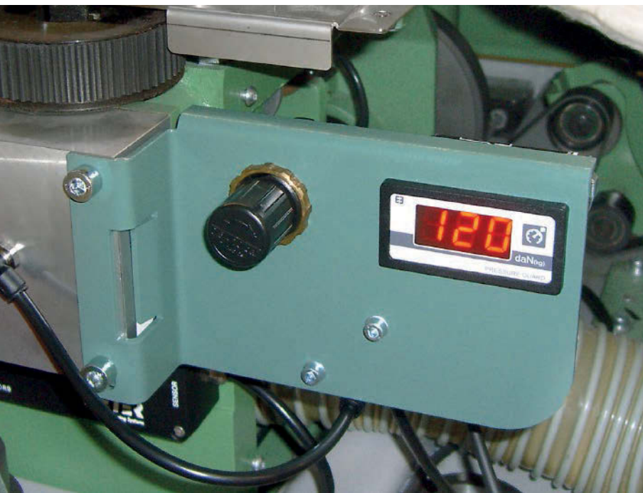
Abb. 1 Auf bestehenden Strecken verhindert die neue Druckluftüberwachung PRESSUREguard unkontrollierte und schlechte Bandqualität.
