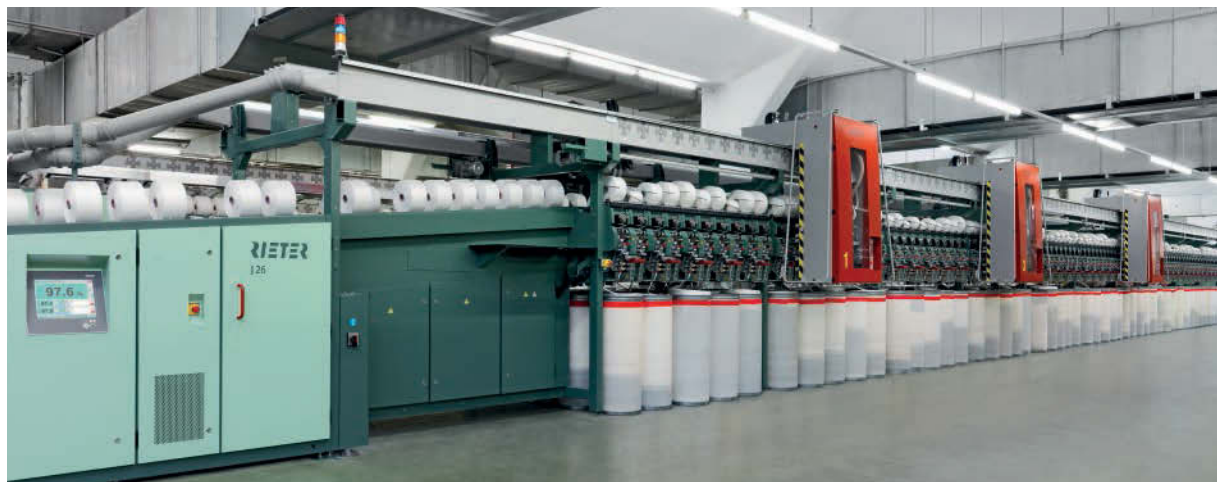
Abb. 2 Kunden können die J 26 mit sechs Robotern bestellen oder mit vier Robotern und vorbereitet für sechs. Das erhöht die Flexibilität bei sich ändernden Marktbedingungen.
