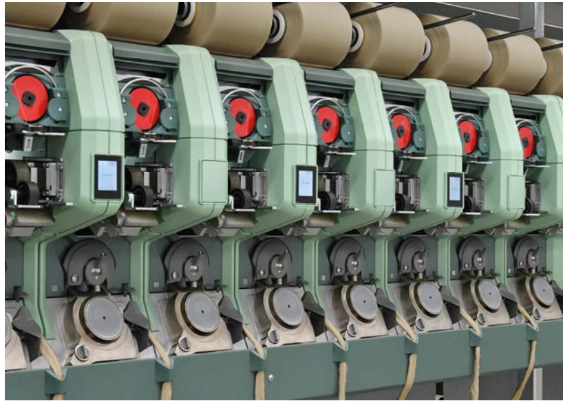
Regel- und Effektgarne lassen sich auf der Rotorspinnmaschine wirtschaftlich produzieren.
