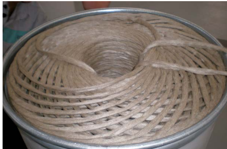
Ideales Vorlageband für die Rotorspinnmaschine
