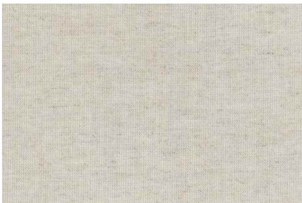
Beschichtungsgewebe Kette: Nm 28/2 Baumwollgarn, ringgesponnen Schuss: Nm 12 Flachsgarn, rotorgesponnen
